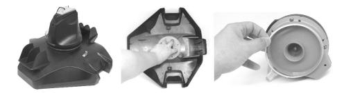
2. Utiliser le tournevis pour dévisser les 4 vis situées en dessous de la tête pivotante pour retirer la plaque inférieure. Utiliser le tournevis pour dévisser toutes les vis de la base comme indiqué. Retirer la turbine, puis soulever la base et la retirer pour exposer la partie intérieure.
